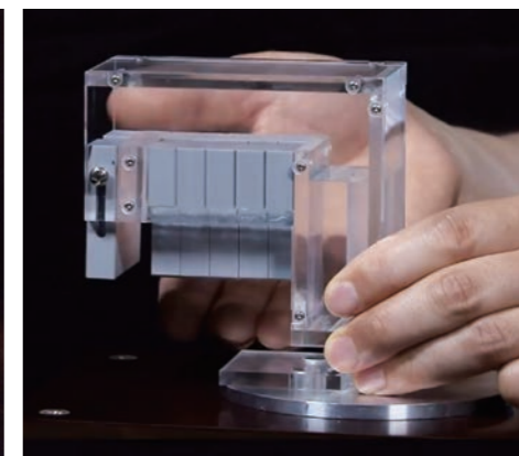
(左) 図1 パイプ型声道模型 (右) 図2 研究用の声道模型の例 (YouTubeより) https://www.youtube.com/watch?v=BKbbQC0WKvQ
