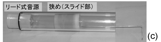
図-2 スライド式声道模型の製作手順 (a) リード式音源, (b) スライド部, (c) 組立後
